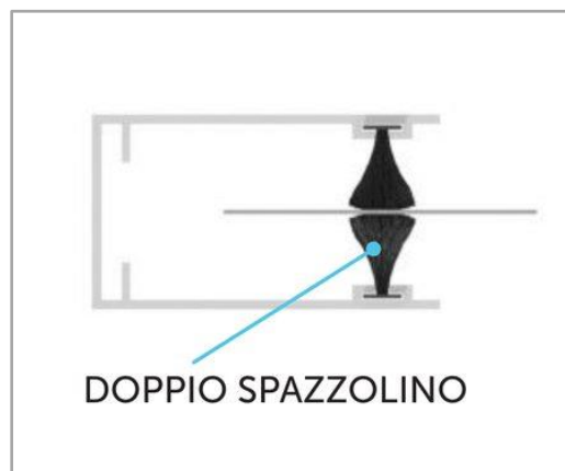
In sezione: doppio spazzolino di appoggio
