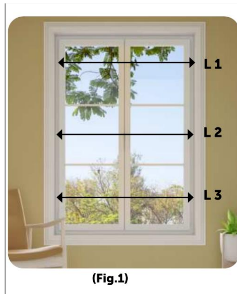
Dentro il vano: misura in tre punti (L1, L2, L3) e comunica la più piccola.
